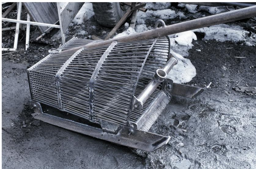
Рис. 2. Механическая драга, использованная в ходе промышленного лова корбикулы японской в оз. Айнском в 2017 г.
