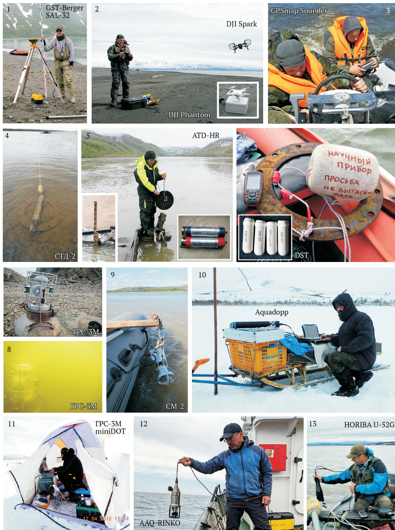
Рис. 8. Примеры оборудования и полевых гидролого-морфологических работ в эстуариях Камчатки в 2010–2022 гг. (1 — картографические работы, бух. Вилючинская, июнь 2019 г.; 2 — аэровизуальные наблюдения, р. Камчатка, июль 2020 г.; 3 — промеры глубин, р. Хайрюзова, июль 2012 г.; установка автономных гидрологических постов: 4 — р. Пенжина, июль 2014 г.; 5 — р. Камчатка, июль 2019 г.; 6 — р. Вывенка, июль 2021 г.; измерения скорости течений и расходов воды: 7–9 — р. Пенжина, июль 2015 г.; 10 — р. Пенжина, ►
