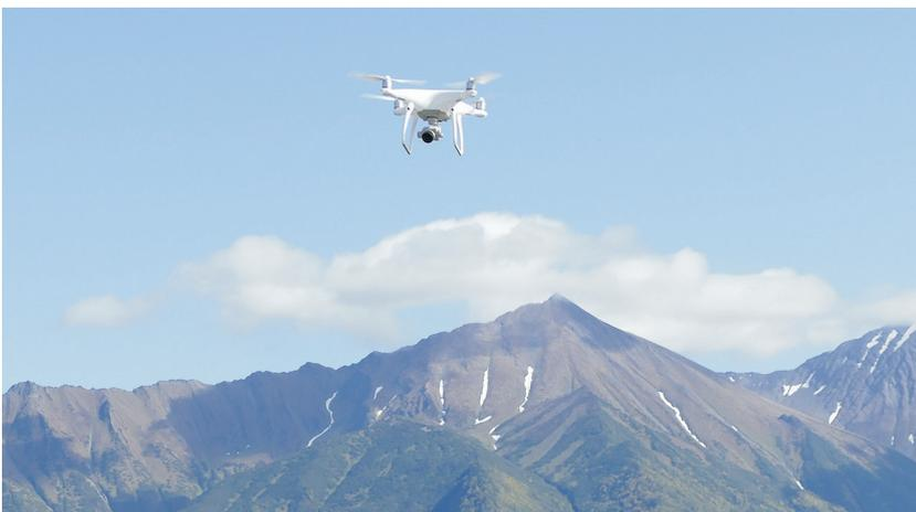
Рис. 2. Квадрокоптер Phantom-4 с трехосной видеокамерой
