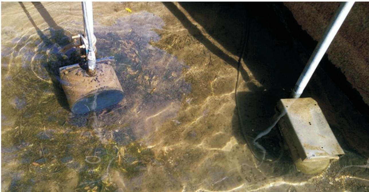
Рис. 4. Расположение излучателей гидроакустических приборов в «котле»
