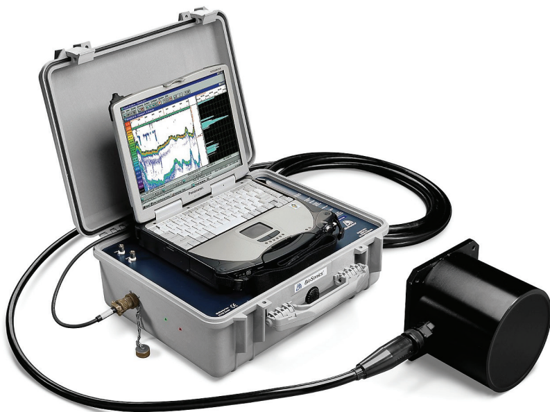
Рис. 4. Специализированный научный цифровой эхолот “BioSonics DT-X”, с помощью которого выполняли гидроакустические съемки на акватории Камчатского залива в 2019–2021 гг. Fig. 4. Specialized digital scientific echosounder “BioSonics DT-X”, used during the hydroacoustic surveys in Kamchatka Gulf in 2019–2021
